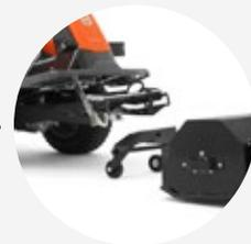
Die Rider der 300er und 400er Serie sind mit einem Befestigungsrahmen ausgestattet, mit dem Sie einfach zwischen Mähdeck und frontmontierten Werkzeugen wie Schlegelmäher, Kehrbürste, Schneefräse und Schneeräumschild wechseln können
