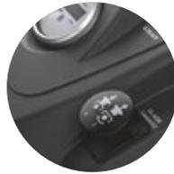
Der Tempomat ermöglicht es, den Traktor auch in schwierigem Gelände mit konstanter Geschwindigkeit zu fahren
