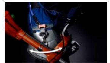
Leicht zugänglicher Auslösemechanismus für den Notfall. Stoßdämpfer, beweglicher Hüftpolster.
