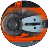
Verwenden Sie immer Husqvarna Kettenöl. Die Verwendung des falschen Öls ist eine häufige Ursache für Ausfälle der Säge und zieht nicht selten einen schnellen Verschleiß der Schiene sowie das Festkleben oder Lösen der Kette von der Schiene nach sich.
