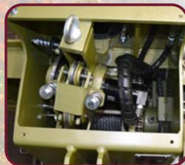
• hydraulischer Seilausstoß mit Spulvorrichtung
