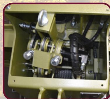
• hydraulischer Seilausstoß mit Spulvorrichtung
