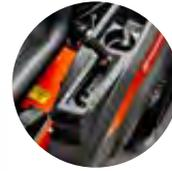
Bequemer, federgestützter Schneidwerkheber
