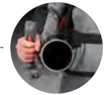
Der Handgriff unserer Blasergeräte ist so positioniert, dass die durch Luftstrom und Motor erzeugten Seitenkräfte aufgehoben werden.
