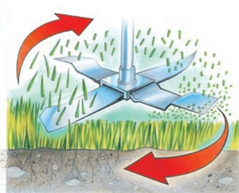
Rotierenden Messer zerkleinern das abgeschnittene Gras in kleinste Partikel, die als natürlicher Dünger auf dem Boden verbleiben können.
