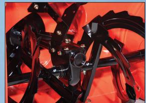
Frostresistentes Hochgeschwindigkeitsschleuderrad mit 35,6 cm Durchmesser
