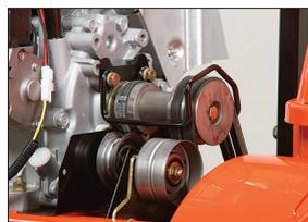
Zwei Keilriemen am Fräsantrieb für mehr Kraft und weniger Verschleiß
