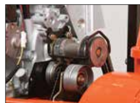
Zwei Keilriemen am Fräsantrieb für mehr Kraft und weniger Verschleiß
