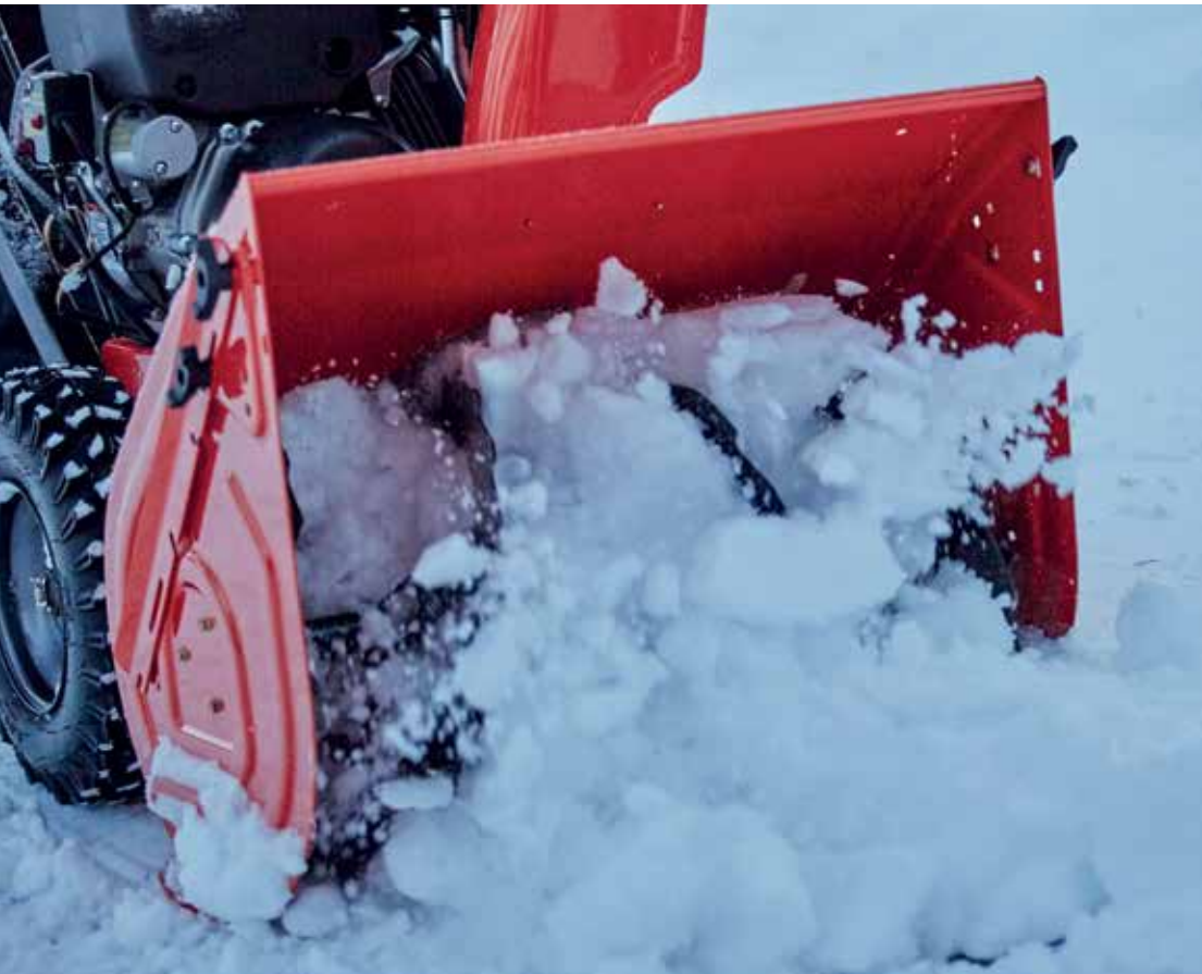
Frostresistentes Hochgeschwindigkeitsschleuderrad mit 36,5 cm Durchmesser
